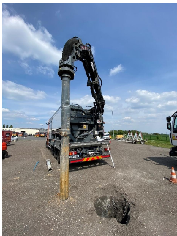
Aspiratrice Excavatrice en action
